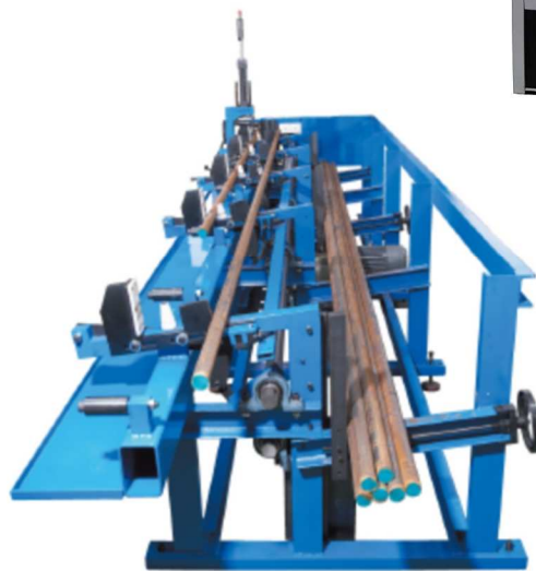
MBL6 - Caricatore a fascio 4.000 kg (brevetto mondiale) Risparmio del 70% di lavoro e tempo di cambio barra
